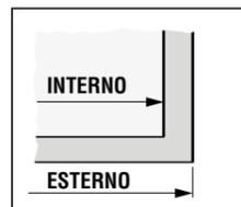
**FARE MOLTA ATTENZIONE A RIPORTARE CON CURA LE QUOTE RILEVATE SUL DISEGNO ESPLICATIVO DEL RILIEVO:** un bordo interno oppure esterno se mal interpretato, darà luogo all'esecuzione di una cabina doccia errata.
