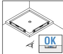
VERIFICARE CHE IL PIATTO DOCCIA O IL PIANO D'APPOGGIO DELLA CABINA DOCCIA SIA IN BOLLA IN ENTRAMBI I SENSI (longitudinale e latitudinale). **SEGNALARE DI QUANTO ED IN CHE SENSO SI MANIFESTA LA PENDENZA NEL CASO.**
